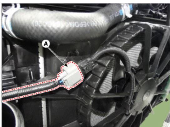
5. 拧下固定螺栓，并拆卸冷却风扇 (A)。
